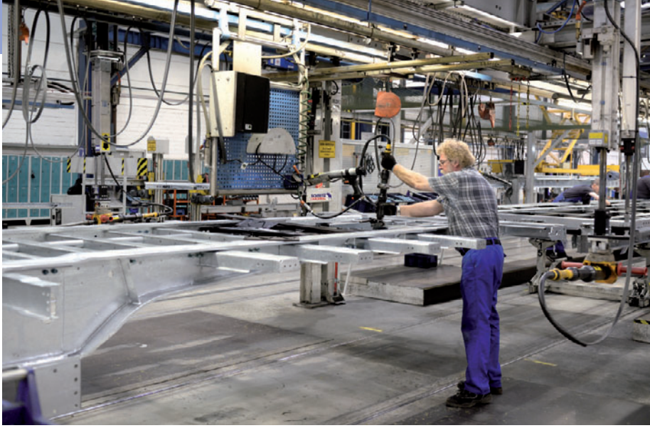
Hart im Nehmen: Verbolzen stückverzinkter Chassis-Komponenten.
