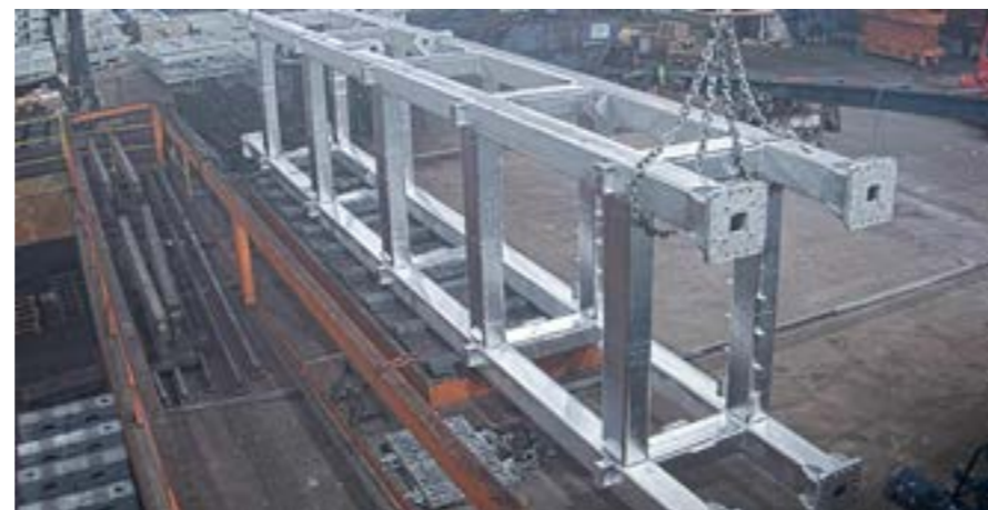
Element der Verkehrszeichenbrücke nach der Fertigung (linkes Bild) und nach dem Verzinken (rechtes Bild).
