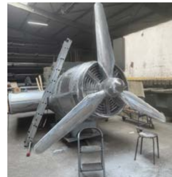
Douglas C-47: Beim Zusammenbauen der Gondel-Einzelteile in der Werkstatt der Schlosserei Neumann. © Schlosserei Neumann GmbH
